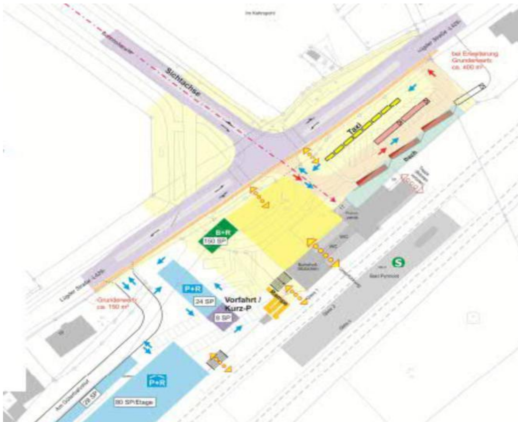
Abb. 39 Variantenuntersuchung Machbarkeitsstudie (2017): Alternative Variante mit LSA-geregeltem Knotenpunkt (verworfen)
