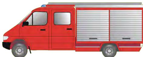
Fahrzeug mit feuerwehrtechnischer Beladung für eine Gruppe. Ein TSF wird vornehmlich zur Bekämpfung kleinerer Brände eingesetzt. Als TSF-T (alte Norm) war es vorgesehen für eine Truppbesatzung, als TSF-W (aktuelle Norm) ist es wasserführend.
