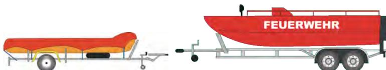
Anhänger zum Transport von Booten für die Wasserrettung. Dies können Schlauchboote oder auch Boote mit einem Rumpf aus festem Material wie GFK sein.
