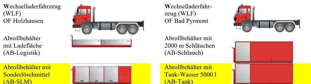
Abb. 8.3-2: Fahrzeuge und Abrollbehälter (gelb hinterlegt: weitere Einsatzmöglichkeiten)
