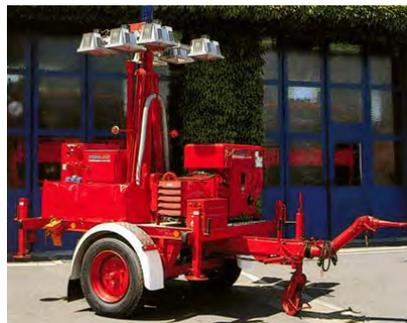
Anhänger mit einem Lichtmast zur Ausleuchtung von Einsatzstellen. Je nach Leistungsfähigkeit des Generators kann auch elektrische Energie für zusätzliche Verbraucher bereitgestellt werden.
