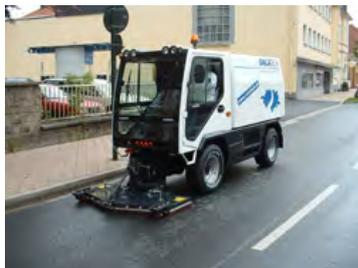
Fahrzeug zur Beseitigung von Ölspuren auf Fahrbahnoberflächen. Es wird mit speziellen Rotordüsen ein Wassergemisch unter Hochdruck auf die zu reinigende Fläche aufgebracht. Im gleichen Arbeitsgang wird durch ein Zweikammer-Vakuumsystem der abgelöste Schmutz mit dem Wasser abgesaugt. Auch Wände und schwer zugängliche Stellen können mit einer Reinigungslanze schnell gesäubert werden.
