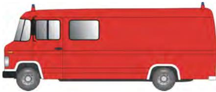
Dieses Fahrzeug dient dem Messen, Spüren und Melden radioaktiver und chemischer Kontamination, der Suche nach radioaktiven Trümmern und der Kennzeichnung und messtechnischen Überwachung kontaminierter Bereiche auch abseits befestigter Wege. Die Besatzung besteht aus 4 Personen. Mit der verlasteten Ausstattung können radiologische und chemische Messwerte sowie Ortskoordinaten automatisch erfasst und – soweit erforderlich – nach rechnergestützter Aufbereitung an die Leitstelle übermittelt werden.
